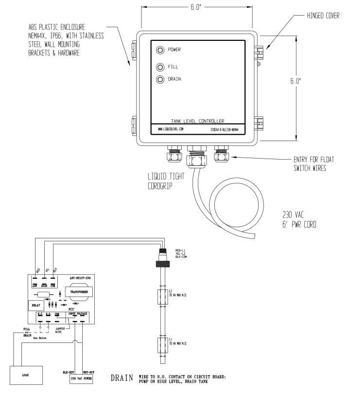
FILL — WIRE TO N.C. CONTACT ON CIRCUIT BOARD: PUMP ON LOW LEVEL, FILL TANK
